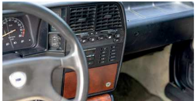
Gli interni della III serie si riconoscono per pochi dettagli: una diversa pulsantiera del check computer e il tasto, fregiato dalla lettera "P", per le luci di parcheggio, prerogativa del modello.
